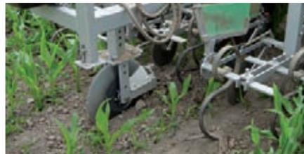
*Le traceur à l'arrière de la bineuse réalise une trace profonde de 20 cm.*
